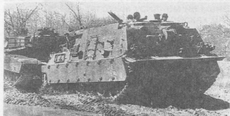
Рис. 1. БРЭМ M88A1E1 буксирует танк M1A1 «Абрамс» в ходе испытаний
